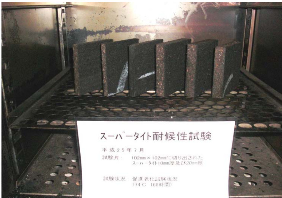
スーパータイト耐候性試験 平成25年7月 試験片： 102mm×102mmに切り出された スーパータイト10mm厚及び20mm厚 試験状況： 試験前、試験片採取
