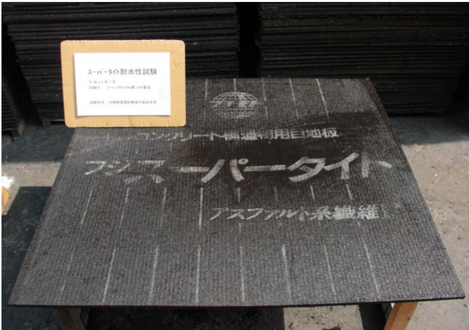
耐水性試験 1㎡製品による完全浸漬 試験 24時間浸漬試験後の 製品状況 (10mm厚製品) (写真-2)
