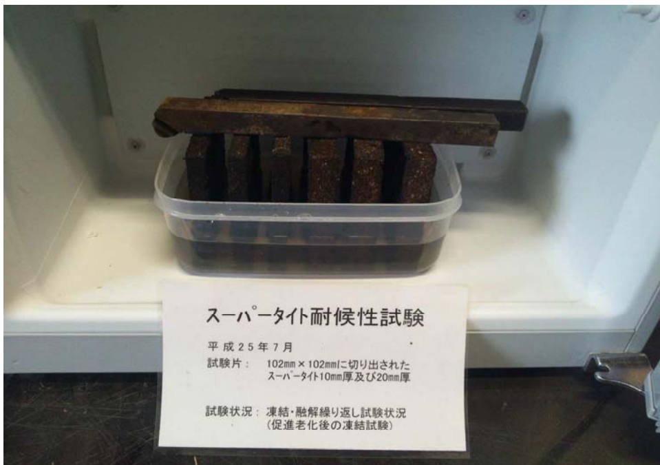
スーパータイト耐候性試験 平成25年7月 試験片： 102mm×102mmに切り出された スーパータイト10mm厚及び20mm厚 試験状況： 促進老化試験状況 (74℃ 168時間)
