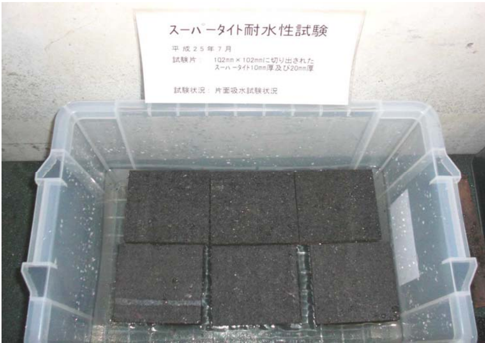
耐水性試験 片面吸水試験状況
