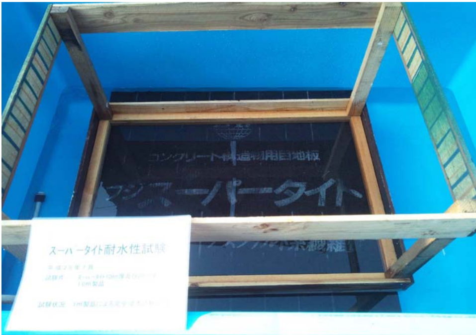
耐水性試験 1㎡製品による完全浸漬 試験状況 (写真-1)
